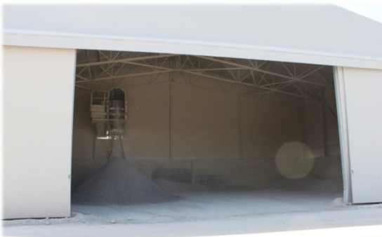
Kuva 20 ja 21. Hiekkoitushiekan kuljettimen pää hallissa. Kuljetinten päissä oleva kastelu estää tehokkaasti kiviaineskasojen pölyämisen.
