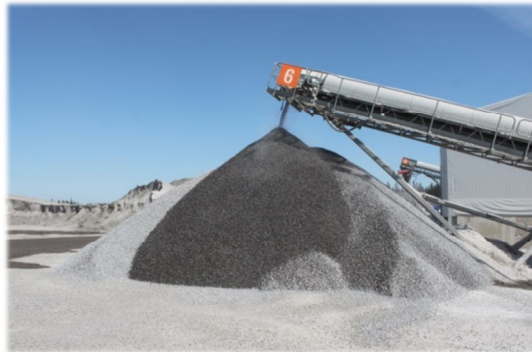
Kuva 20 ja 21. Hiekkoitushiekan kuljettimen pää hallissa. Kuljetinten päissä oleva kastelu estää tehokkaasti kiviaineskasojen pölyämisen.
